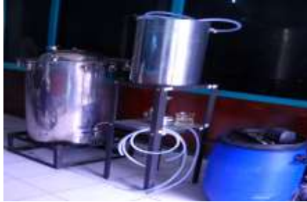
Gambar 12. Peralatan pengolahan minyak kayu putih
